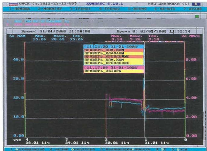
Рис. 10. Экран «ТРЕНД» диагностических признаков с выводом сообщений экспертной системы поддержки принятия решений
